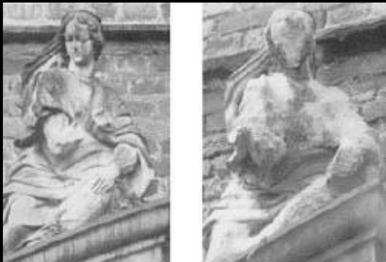
Desgaste ocasionado pela chuva ácida num período de 60 anos - estátua de mármore localizada no Castelo de Herten, na Alemanha.
